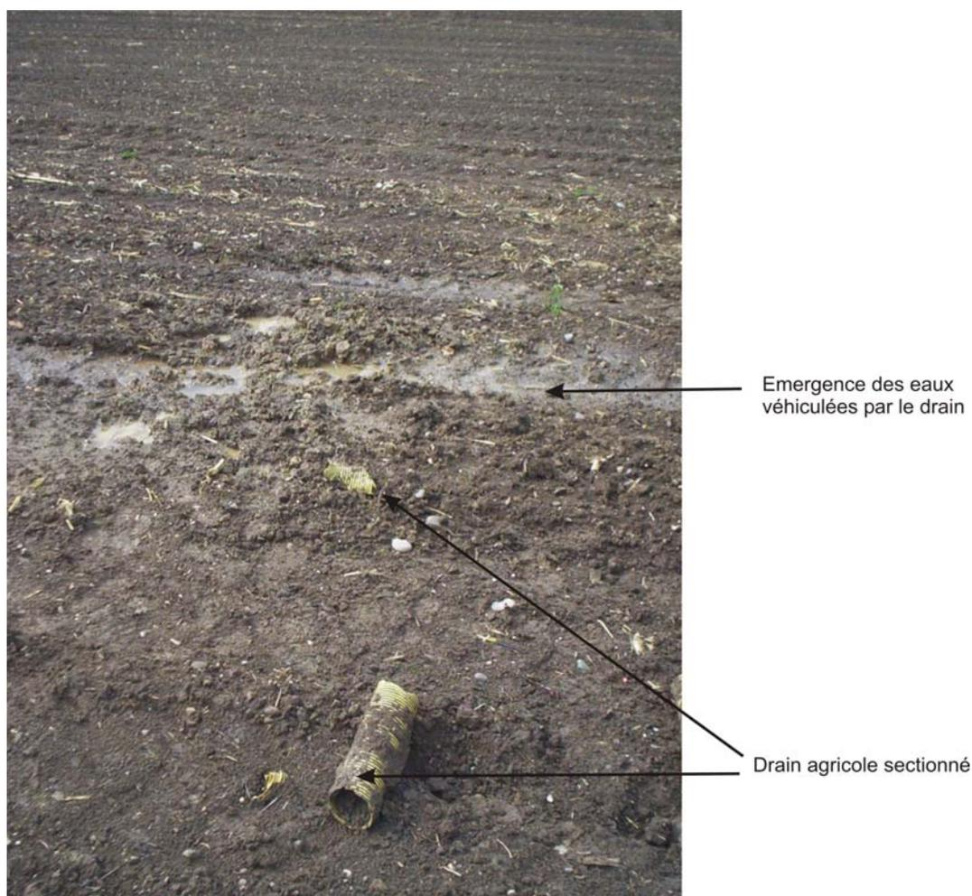
Débris du drain n°2 sectionné à mi hauteur par des labours (avril 2006)
